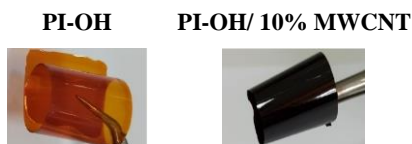
Figura 18. Imagini ale filmului de referință PI-OH și ale filmului nanocompozit cu 10% MWCNT
